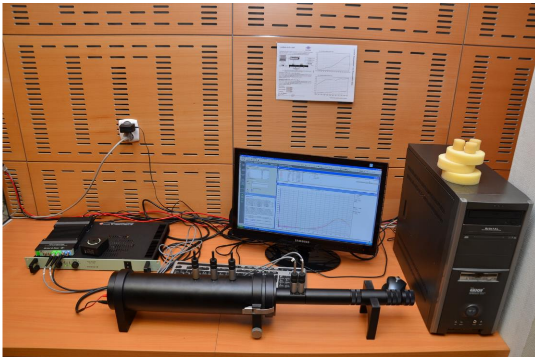
Fot. 1. Stanowiska do pomiaru współczynnika pochłaniania dźwięku w rurze impedancyjnej.
